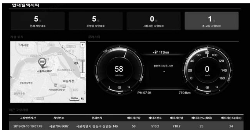
배터리 충전 현황, 배터리 상태, 주행 가능 거리, 차량 고장 안내 등 전기버스의 주요 기능이 관제 시스템에 연동된 실시간 모니터링 화면 (본 사진은 차량의 고장 안내 기능 이해를 돕기 위해 연출된 장면) /현대차 제공
